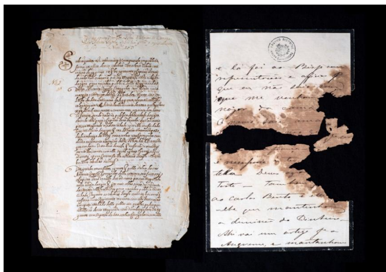
Figura 8. La industrialización de la producción de papel introducirá el uso de fibras extraídas de la madera, de la cual se obtendrá un papel con un alto porcentaje de impurezas (lignina) y un elevado nivel de acidez. El impacto de este cambio en la materia prima es perceptible en la comparativa de estas imágenes, que corresponden a un documento datado en el siglo XVIII y otro en el XIX. El primero, manufacturado, presenta un buen estado de conservación, pese a ser más antiguo y encontrarse en las mismas condiciones de almacenamiento que el segundo. Fotografías de Gonçalo Simões.
